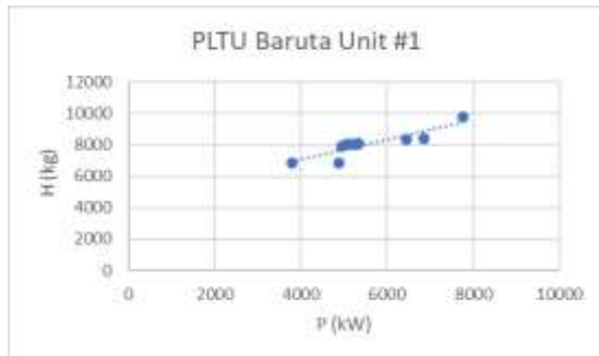
Gambar 2 Grafik hubungan antara Daya yang dibangkitkan dengan Bahan bakar yang diperlukan pada PLTU Baruta Unit #1
