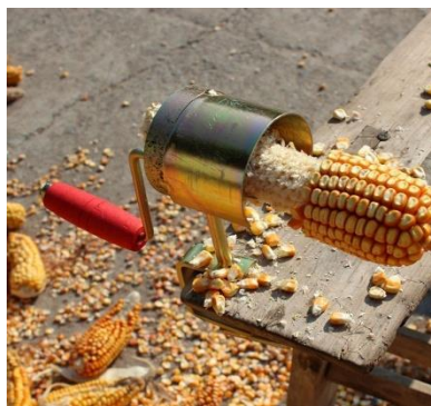
Gambar 2 alat pemipil jagung sederhana dengan tuas
