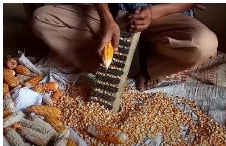
Gambar 1 alat pemipil jagung sederhana dengan karet ban
