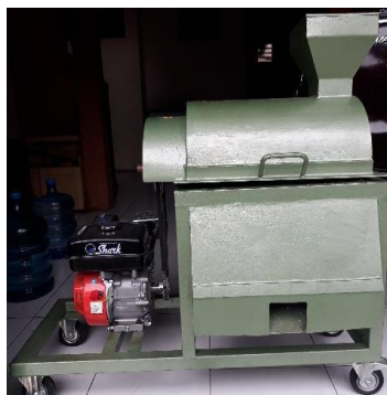
Gambar 5 alat pemipil jagung dengan penggerak motor bakar
