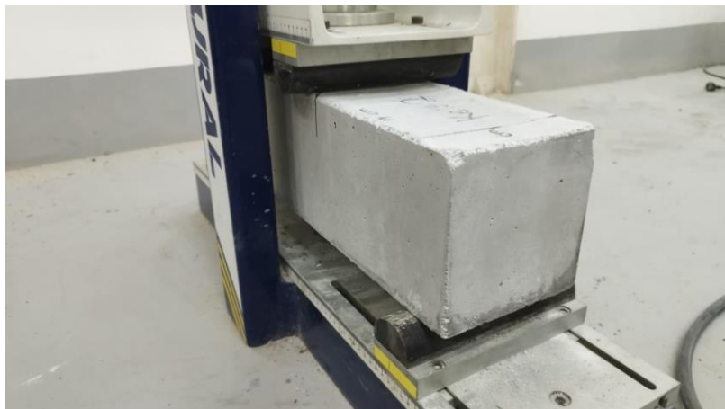
Gambar 2. Dokumentasi mahasiswa praktikum uji kuat lentur beton di laboratorium teknik sipil
