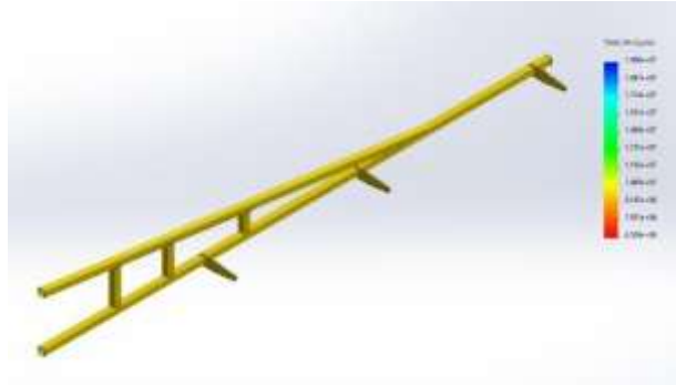
Gambar 18. Batas ketahanan baru (50 mm x 50 mm ketebalan 1,2 mm) menggunakan ASTM A36 SN Curve
