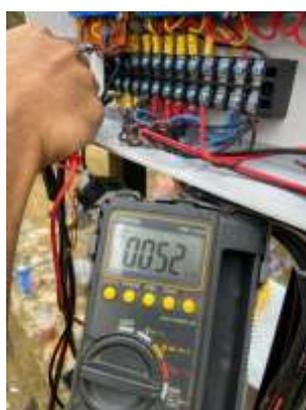
**Gambar 2.26 Pengujian Arus Panel Surya**
