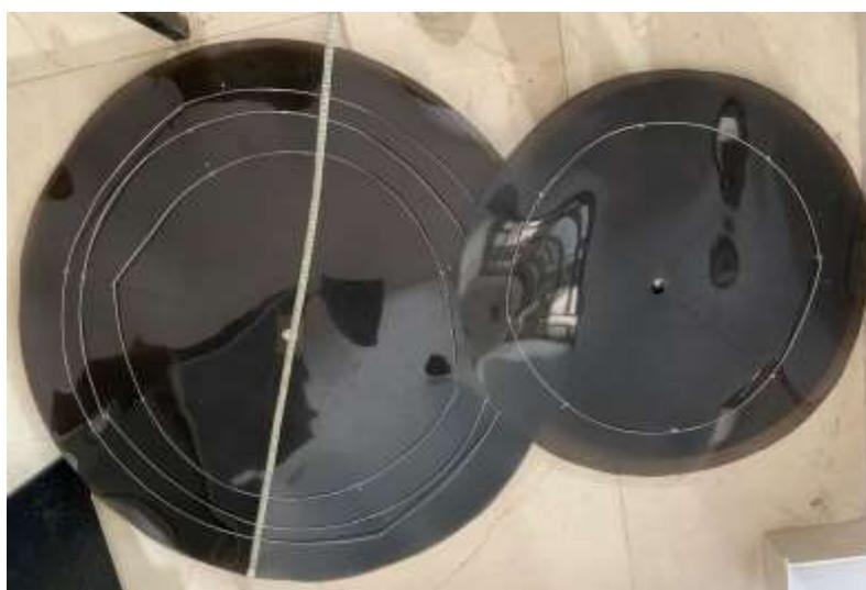
**Gambar 2.** *End plate* turbin.
